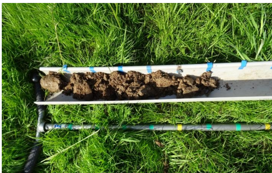
Figure 13 : Sondage pédologique avec traits d'hydromorphie significatifs – T. Sévellec - Écosphère
