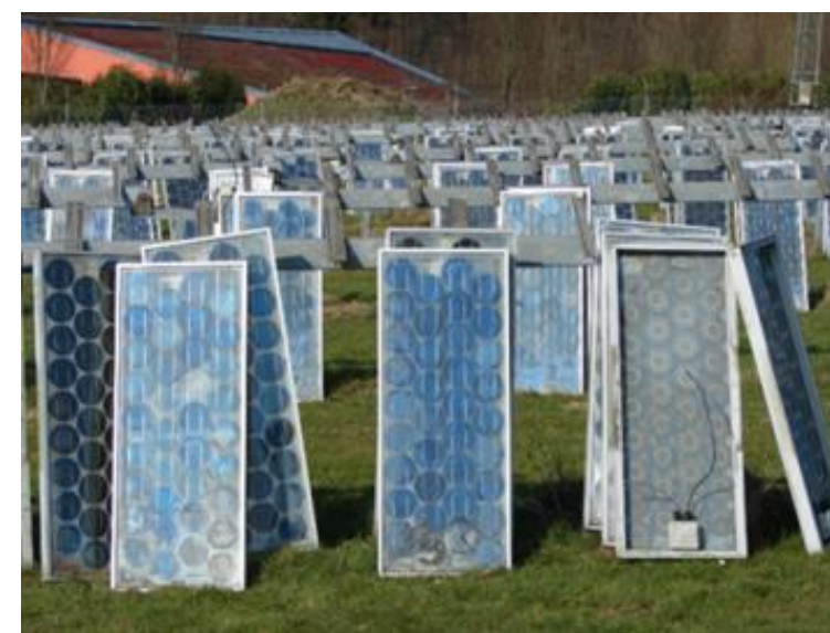
Figure 50 : Panneaux photovoltaïques en fin de vie (source : PV cycle, 2015)
